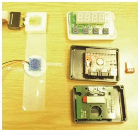
Рис. 3. Схемы внешнего управления: задание параметров измерения (2 варианта), CODEC TCP/IP в RS 485, вариант размещения датчика капиллярных колебаний (дифференциальный), тензорезистор (степень локомоции, микропотоки тепла), пьезодатчик (давление, вариации пульса), акупунктурные датчики теплового потока. Материал браслета – Flex-Omega
