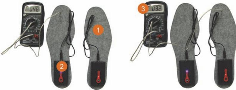
**1 – Стелька со встроенным нагревательным элементом 2 – Аккумулятор с регулятором уровня нагрева 3 – Прибор для измерения температуры на поверхности стельки**
