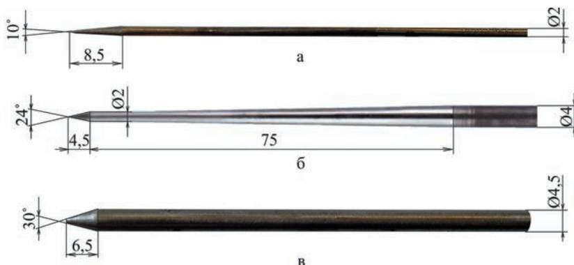
Инденторы для испытаний на прокол: а – индентор диаметром 2 мм и углом заточки  $10^\circ$ ; б – индентор стандарта NIJ-0115.00 с изменяющимся по длине диаметром от 2 до 4 мм и углом заточки  $24^\circ$ ; в – индентор стандарта EN 388 и ГОСТ Р 12.4.260-2011 с диаметром 4,5 мм и углом заточки  $30^\circ$
