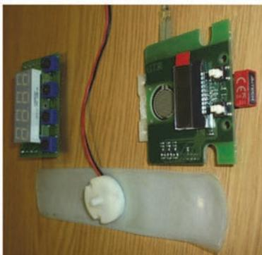
Рис. 4. Составляющие модули биоаналитической системы и вариант подключения пьезодатчика
