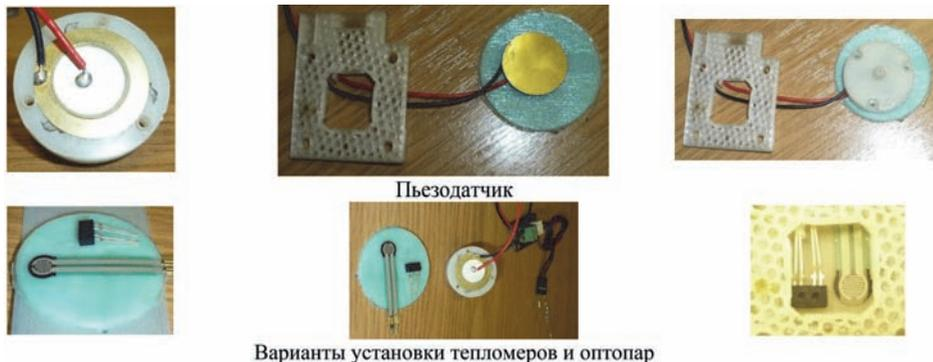
Рис. 2. Применяемые сенсоры и варианты их установки
