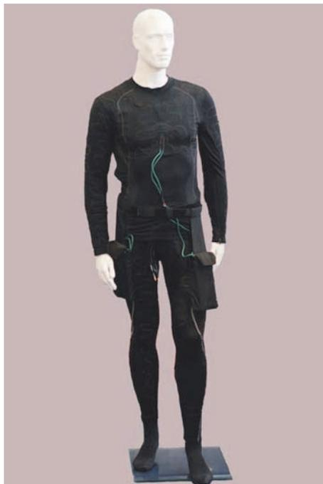
усилия нагревательному проводу. Нагревательный провод – это лавсановые нити с нанесенным на них тонким слоем резистивного металла в полимерной изоляции. Система обогрева футболки состоит из 5 нагревательных элементов, размещенных по одному на рукавах и груди, и два нагревательных элемента на спине. Система обогрева кальсон состоит из 4 нагревательных элементов, по два для обогрева каждой ноги. Температура поверхности нагревательного провода не превышает 40 °С.
