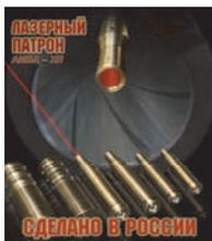
Лазерные патроны (ЛП) применяются для пристрелки стрелкового оружия калибров: **7.62x39, 7.62x51, 7.62x54, .30-06, .300, 20 и 12**. Использование ЛП исключает применение боевых патронов. ЛП устанавливается в патронник вместо боевого патрона, регулировка прицельных устройств производится по лазерной метке на мишени. В отличие от многих аналогов, включение ЛП происходит автоматически при установке его в патронник оружия.
