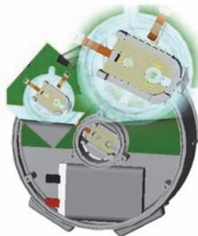
Размещение сенсоров в OEM-устройстве
